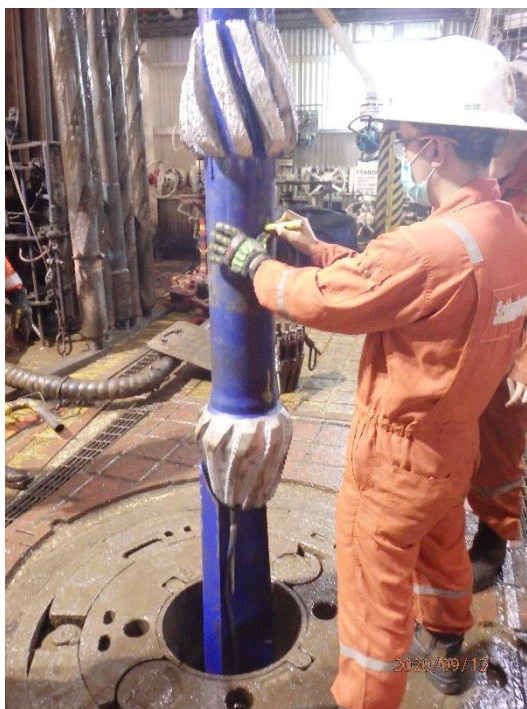
Proses pemasangan whipstock di rig floor untuk pengeboran sumur B-G-4.B1
