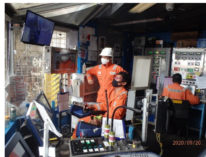
Driller cabin sedang melakukan proses pengeboran sumur B-G-4.B1 diawasi oleh Company Man
